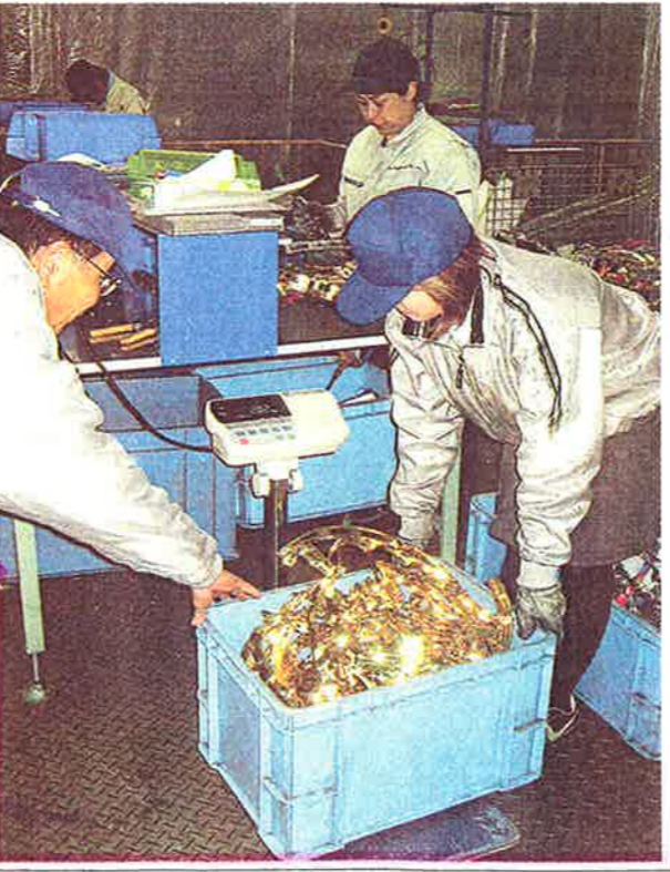
分解した部品の重量を量る作業。CO 2 削減効果計算する「名古屋市のリサイクルテック・ジャパン」
